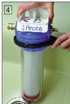
1. Drehen Sie den Absperrhahn am Wasserzulaufschlauch des Filters ab und öffnen kurz den Wasserhahn Ihrer Armatur zur Druckentlastung. Dann lösen Sie die Anschlussschläuche mit den Schnellkupplungen des Filters wie folgt:
