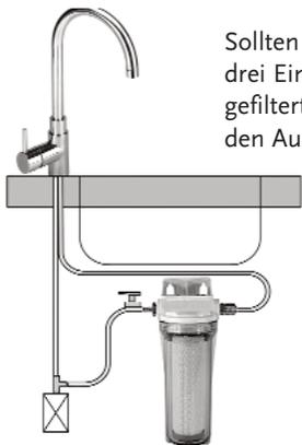
Sollten Sie eine Armatur besitzen, welche drei Eingänge (für kaltes, warmes und gefiltertes Wasser) hat, dann können Sie den Ausgangsschlauch des Filtergerätes direkt an den dritten Eingang Ihrer Armatur anschließen (keine Zusatzarmatur)!
