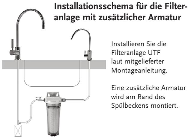
**Installationsschema für die Filteranlage mit zusätzlicher Armatur**
